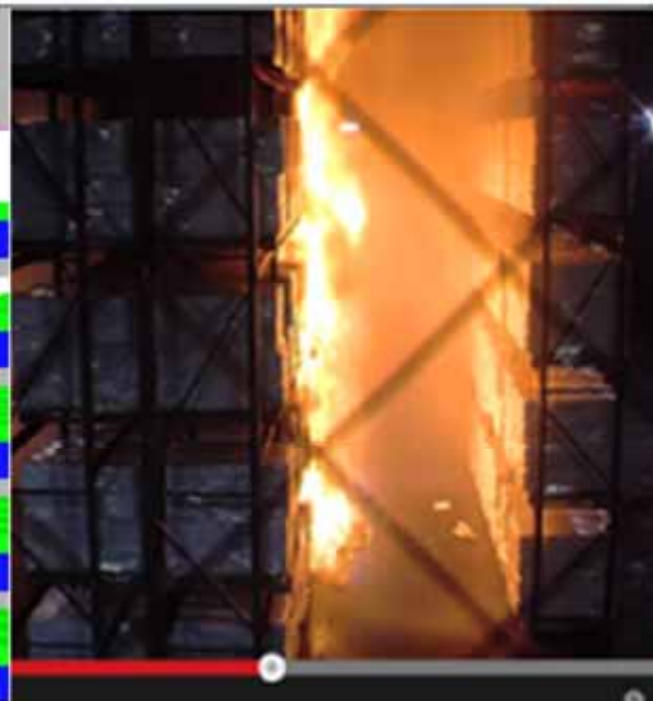
Test NFPA dopo 60 s; si attiva lo sprinkler
