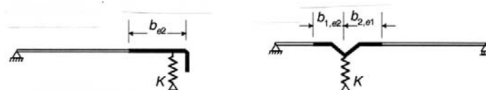
Figura C4.2.31 – Schematizzazione degli irrigidimenti
